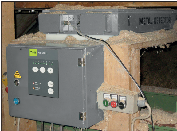
Plate type detector ELS analysing wood off-cuts
