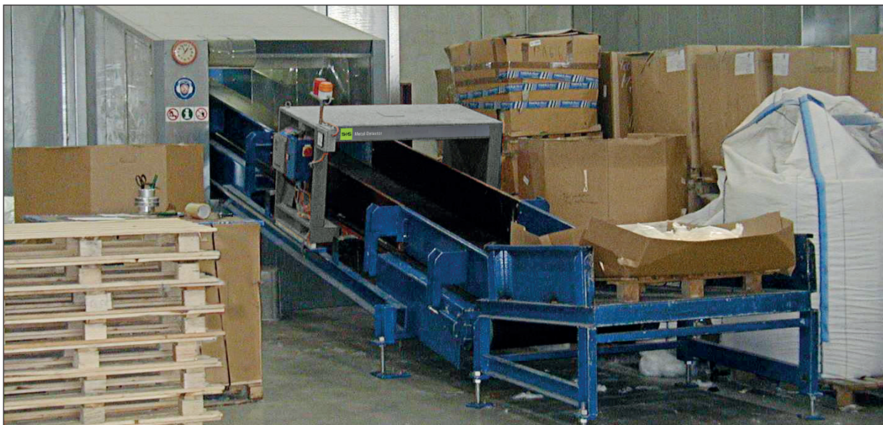
Detector de metales de túnel DLS para inspección de material reciclado antes del molino
